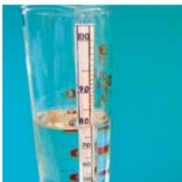
2. A análise pós-produção é obrigatória se for utilizado etanol ou uma solução de isopropanol. Use o alcoômetro para controlar a concentração de álcool da solução final. Os limites aceitos devem ser fixados em  $\pm 5\%$  da concentração-alvo (75%-85% para o etanol).
