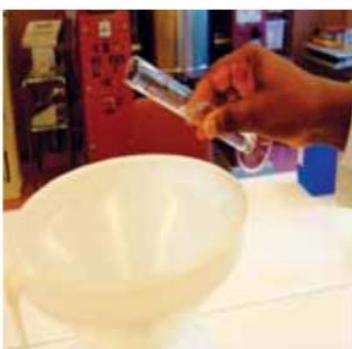
3. O glicerol é adicionado com auxílio da proveta graduada. Como a glicerina é muito viscosa e adere à parede da proveta graduada, esta deve ser lavada com água destilada ou fervida estéril fria e depois esvaziada na garrafa/tanque.
